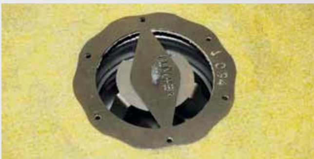
Vid håltagning av tätskikt används BLÜCHER brunnskniv MULTI som skärmall, RSK 712 20 23.
